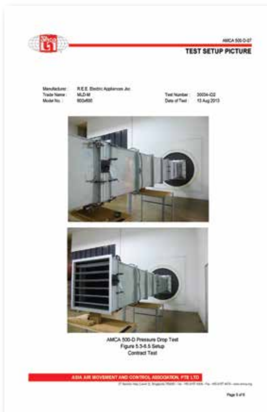
Hệ thống test tổn thất áp suất MLD tại AMCA Singapore
