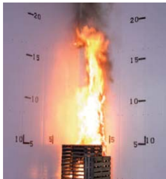
Yangın Dayanım Köşe Testi
