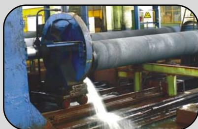
水压实验 Hydraulic test
