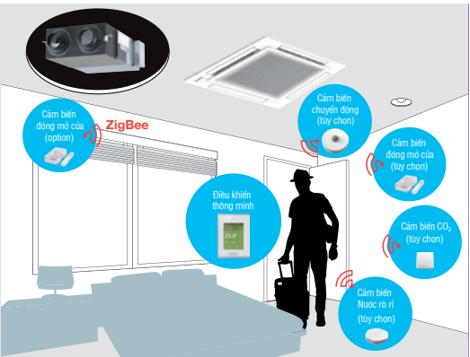
Pin có thể kéo dài đến 5 năm (10 năm với cảm biến CO 2 ), dễ dàng lắp đặt và thay thế
