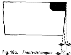
Fig. 18a. Frente del ángulo libre afilado correctamente.
