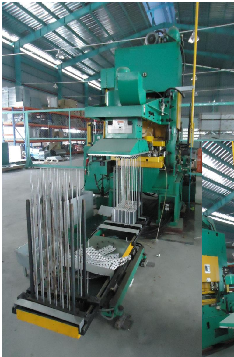
Máy dập lá Fin nhôm Ø12.7. Fin press machine (hole Ø12.7)
