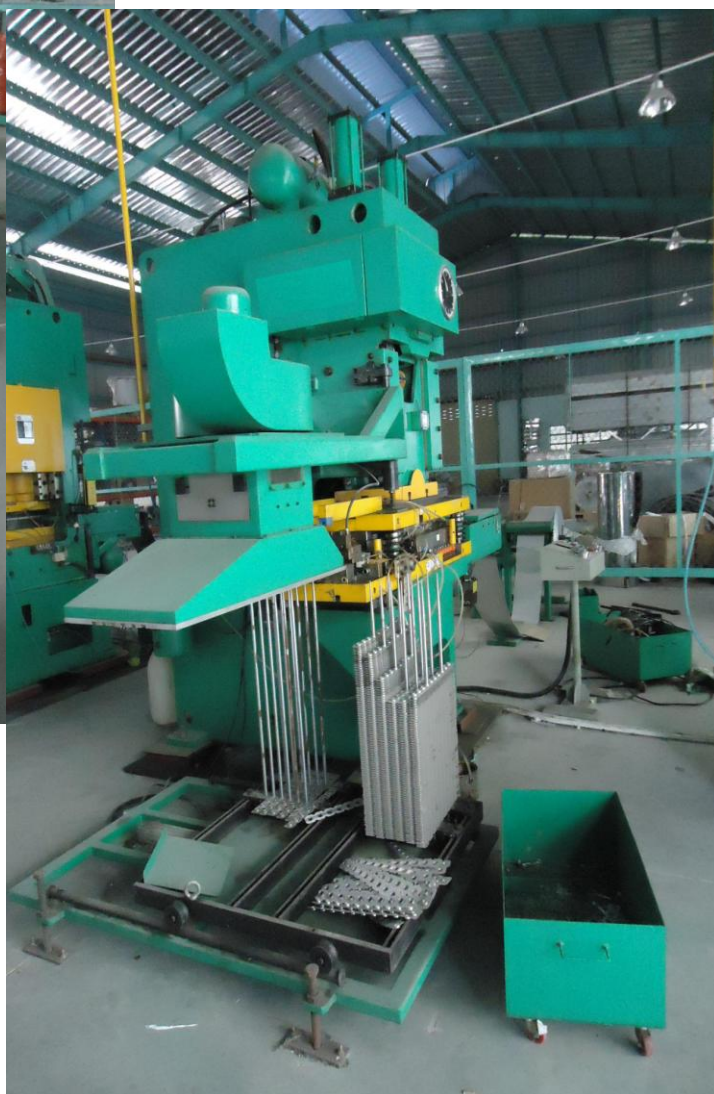
Máy dập lá Fin nhôm Ø16. Fin press machine (hole 16)
