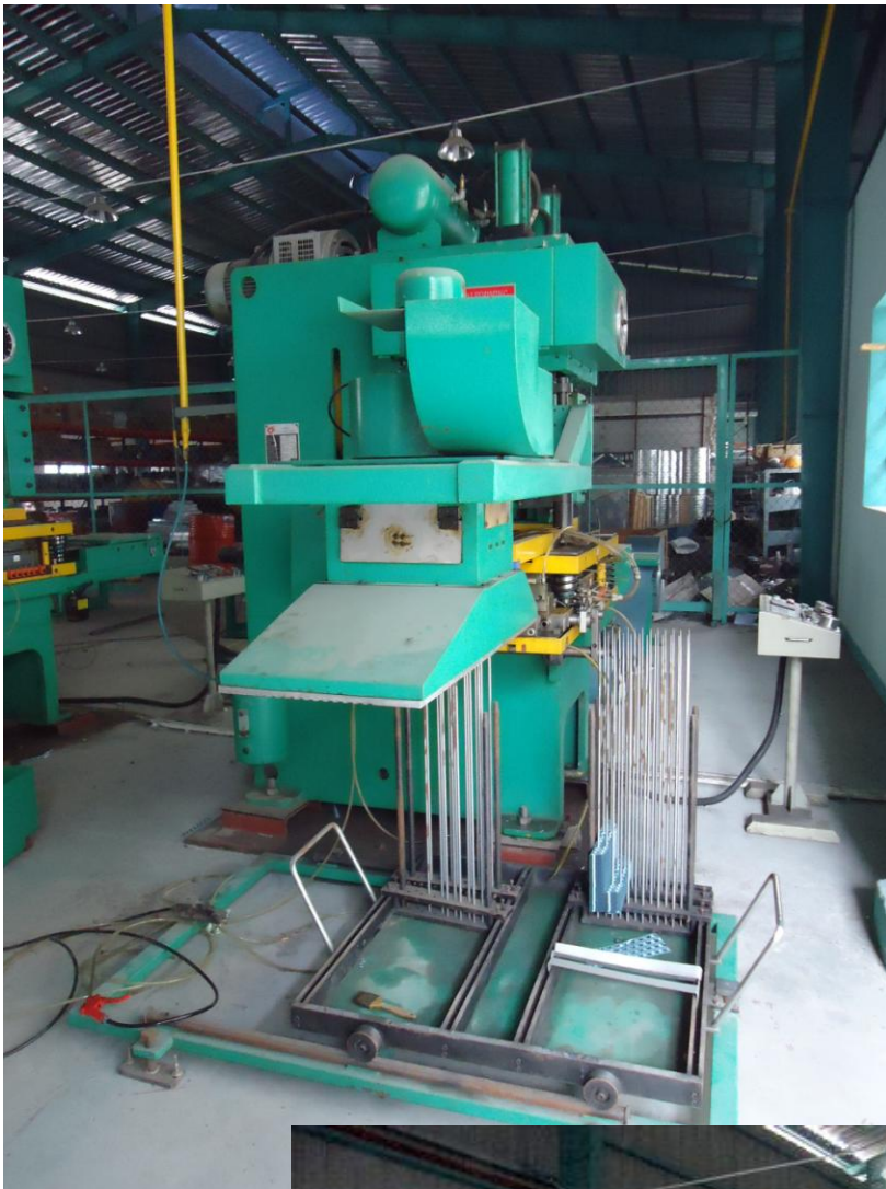
Máy dập lá Fin nhôm Ø10. Fin press machine (hole Ø10)
