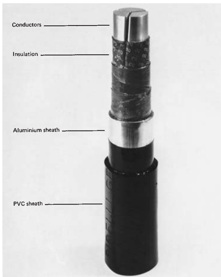
Fig. 19.4 600/1000 V CONSAC cable ( Pirelli Cables Ltd ).
