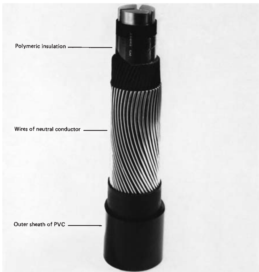
Fig. 19.6 600/1000 V Waveconal cable ( Pirelli Cables Ltd ).
