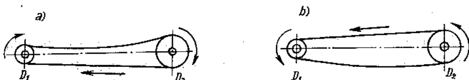
Hình 6.16. Sơ đồ lắp đai truyền
