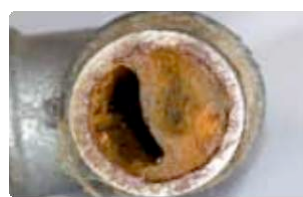
Đường ống với cấu cặn bên trong
