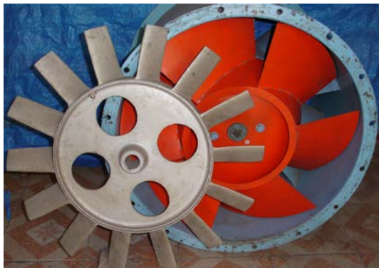
Hình 4: quạt HT 700 và thay thế bằng RotoMF 700
