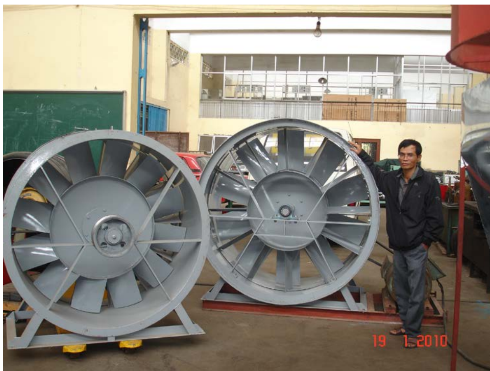
Quạt HT 1 và 2 tầng cánh: Q đến 25\text{m}^3/\text{s} @ 50-100mmH 2 O
