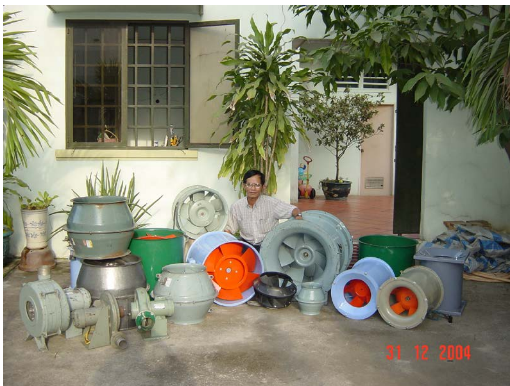
Các dạng quạt Ly tâm, Hướng trục và Mixed flow
