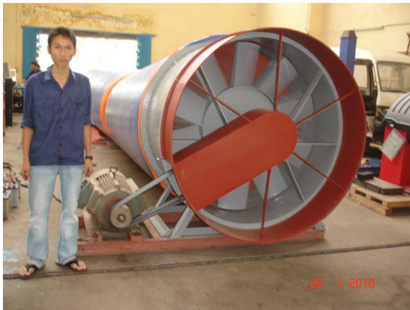
Hình 18: Quạt HT 1500 (truyền động đai) lắp với ống khảo nghiệm quạt 1400
